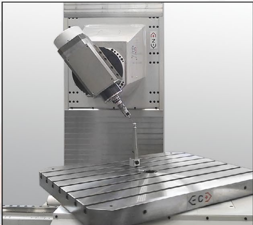
EVO RT Five Macchina in versione 5 assi con tavola girevole e testa tiltante in continuo.
