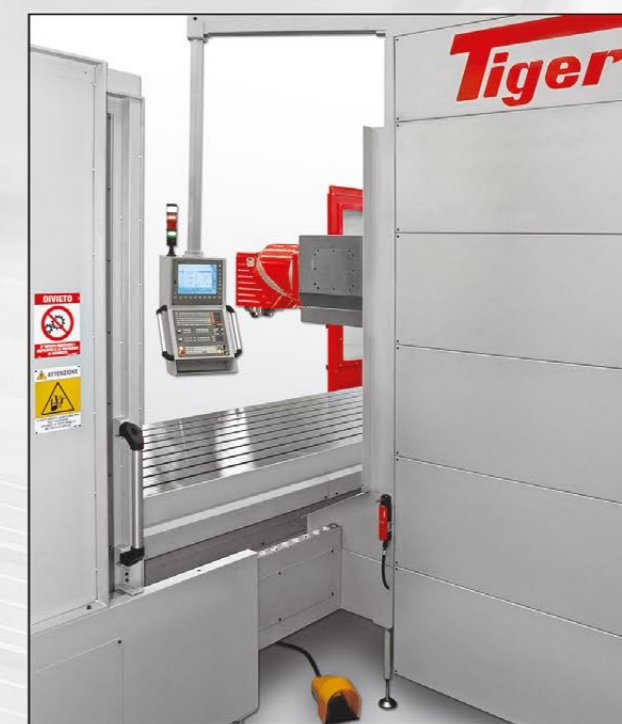
La porta scorrevole nel lato posteriore della carenatura facilita la visione e l'accesso, durante le lavorazioni con mandrino in orizzontale.
